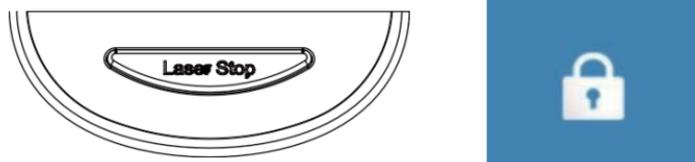
Figure 26 Bouton d'arrêt d'urgence "STOP LASER" et bouton de la machine de verrouillage
